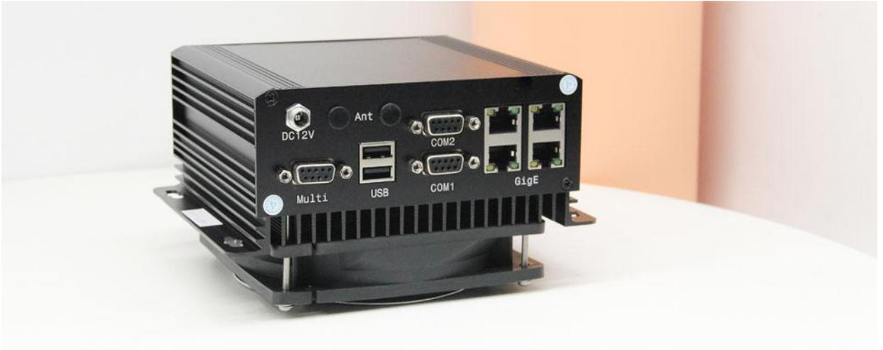
SYS-2006是一款可搭配NVIDIA® Jetson™ Xavier NX、TX2 NX、Nano 系列核心模块的紧凑型AI工控计算机。面向工业部署应用，主要接口进行了静电安全保护设计，采用了高可靠性的电源应用方案，输入电源具有过压与反极性保护功能，具有丰富的对外接口，内部接口载板器件均采用宽温型号。
