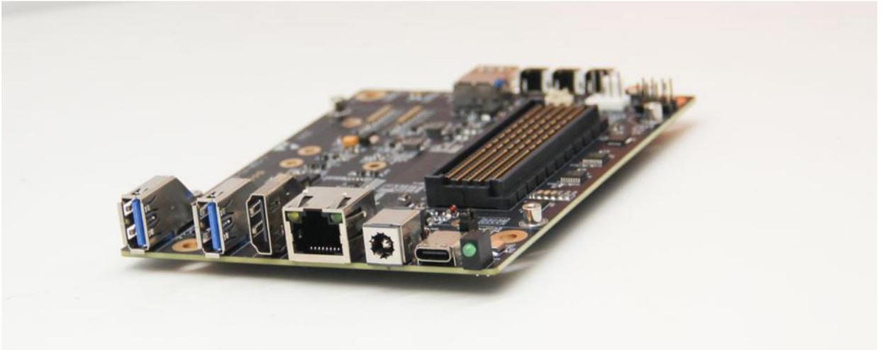
Y-C9是一款适配搭载 NVIDIA Jetson AGX Orin/AGX Xavier系列核心模块的小体积载板。适合紧凑型部署需求。主要接口进行了静电安全保护设计，采用了高可靠性的电源应用方案，输入电源具有过压与反极性保护功能，具有丰富的对外接口，全板器件均采用宽温型号。
